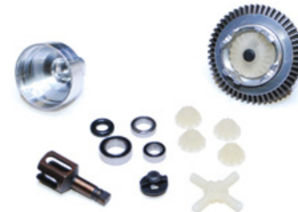
Das serienmäßige Kegeldifferential besteht aus zwei Aluhälften, die mittels Feingewinde miteinander verschraubt werden. Ein O-Ring sorgt für die perfekte Abdichtung
